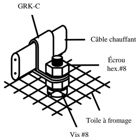
**Toit plat** – De l'adhésif (non fourni) devrait être employé pour lier les boulons des attaches à la surface plate. La surface du toit doit être propre aux endroits d'adhésion. Ne pas percer la surface du toit plat avec vis ou clous pour éviter l'infiltration. Permettre à l'adhésif de durcir à sa pleine capacité avant l'installation du câble ou des attaches.
