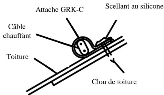
**Toit en bardeaux d'asphalte** – Fixer l'attache avec un clou à toiture. Assurez-vous d'une étanchéité totale en employant du silicone ou un autre scellant approprié.
